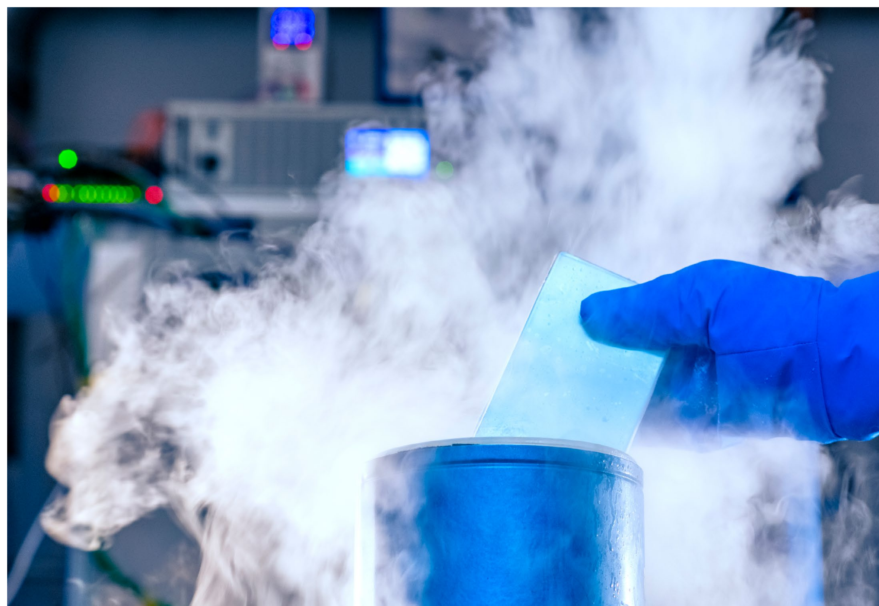
Die BAM erforscht in ihrem Batterietestzentrum, ob Abkühlung das thermische Durchgehen von Akkus stoppt.
