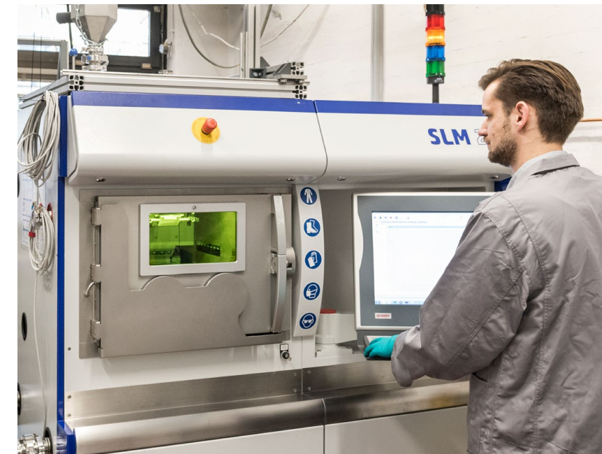
Anlage für das Laserstrahlschmelzen im Pulverbett an der BAM
