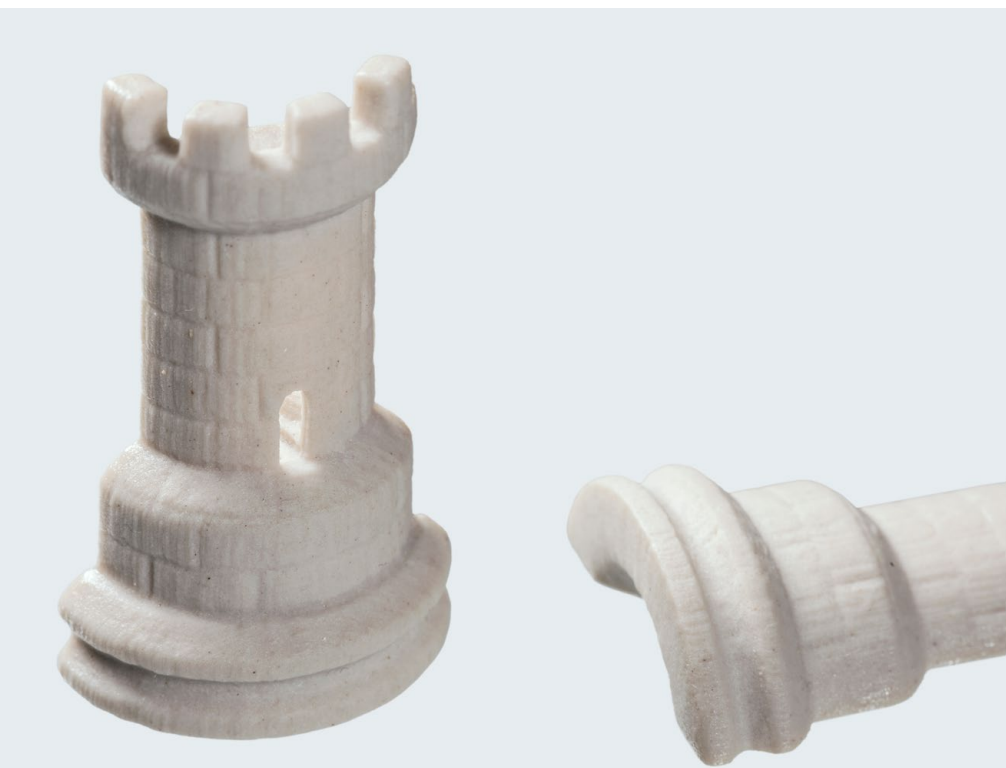
Bauteile aus Silikatkeramik, die mittels LSD Prozess hergestellt wurden
