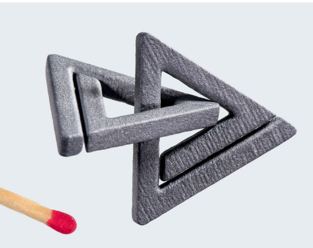
Bauteile aus Siliciumcarbid (SiC), die mittels LSD Prozess hergestellt wurden
