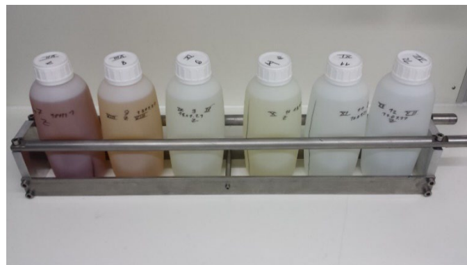
Abb. 2: Quetscheinrichtung mit Testflaschen aus PE-HD
