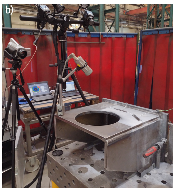
a) Quereigenspannungsprofile für freischumpfende und selbstbeanspruchte Proben (S500MLO); b) Instrumentierter Bauteilversuch bei Fa. Tadano Demag (S960QL, Mobilkranbau)
