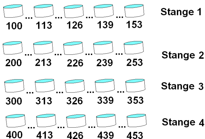
Abb. 6: Probenauswahl bei Prüfung der axialen Homogenität
