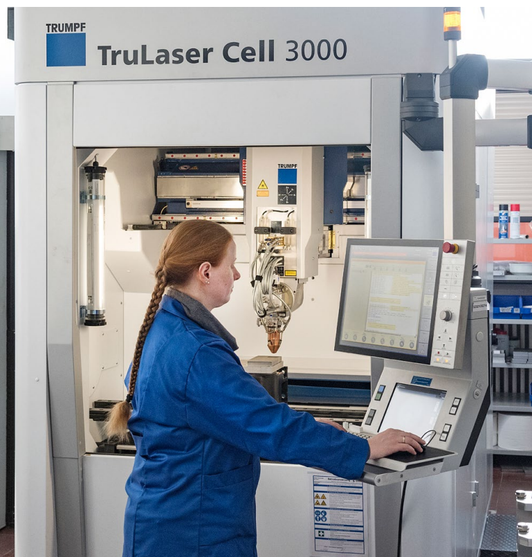
Arbeit an der Anlage für das Laser-Pulver-Auftragschweißen an der BAM
