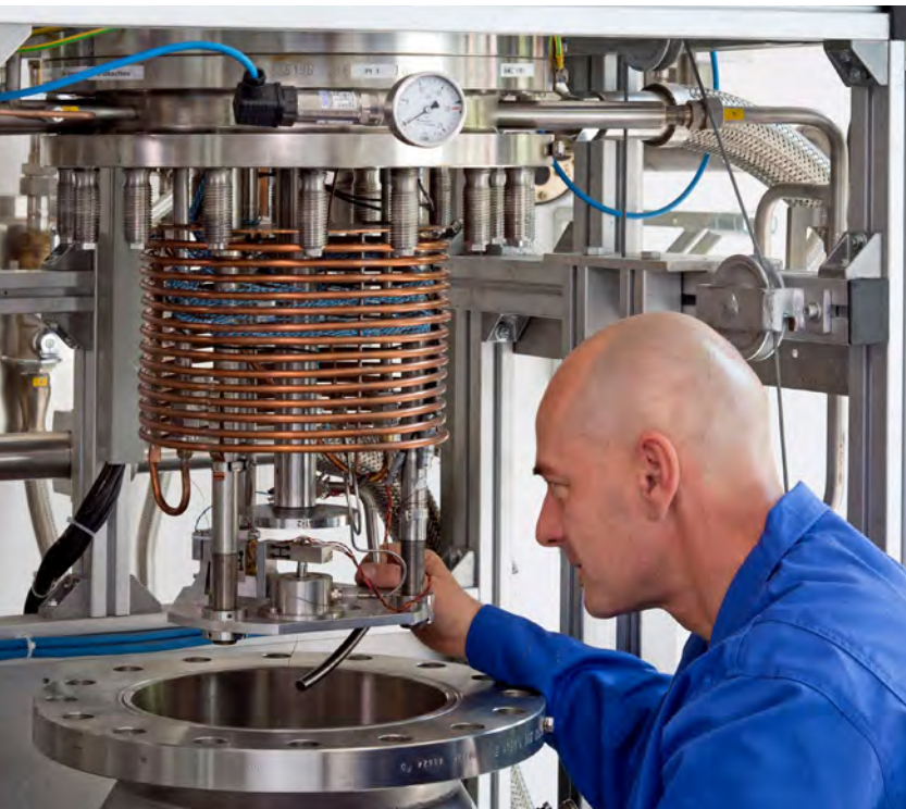
Probeneinbau und -justage für eine Reibungsmessung in flüssigem Wasserstoff
