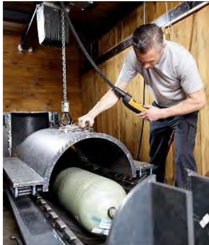
Vorbereitung einer Berstprüfung an Druckbehältern
