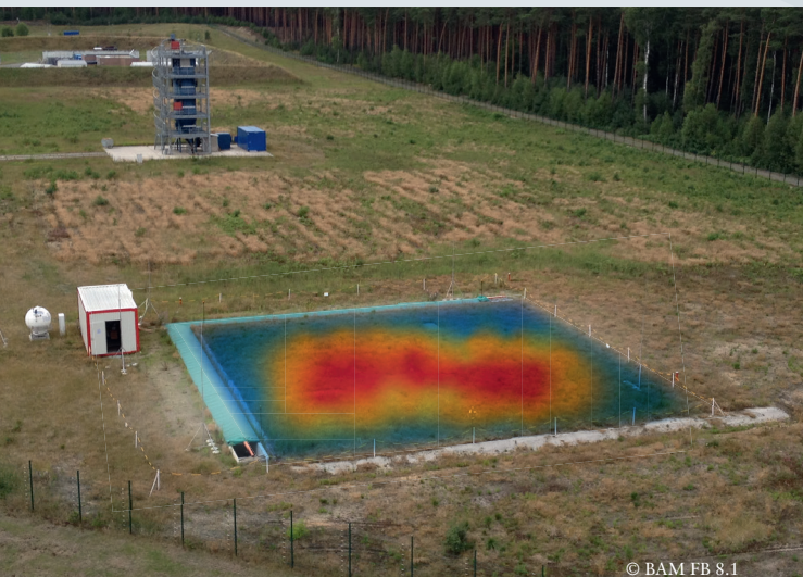
Testfeld verteilte Gassensorik mit Gasinjektionssystem
