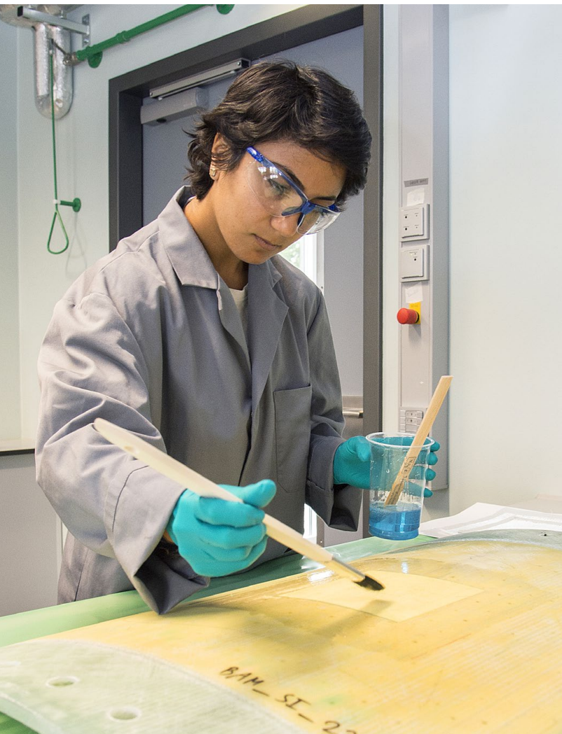
Handarbeit: Reparatur der Schale eines Rotorblatts
