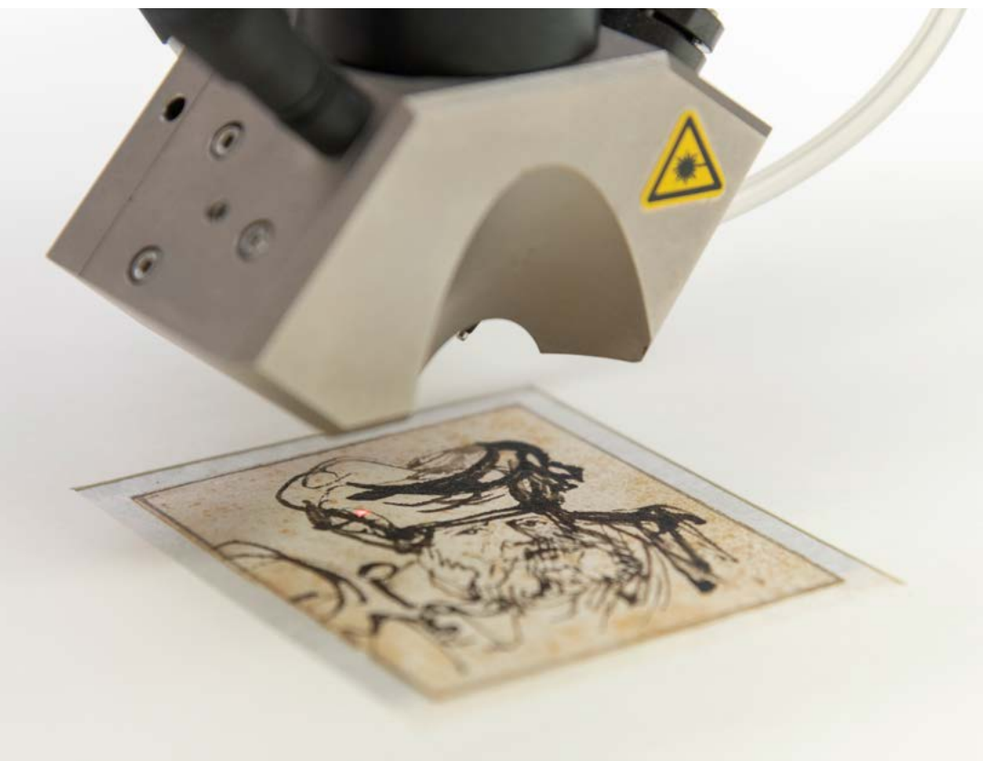
Rembrandt-Zeichnung unter dem Röntgenflu- oreszenzspektrometer
