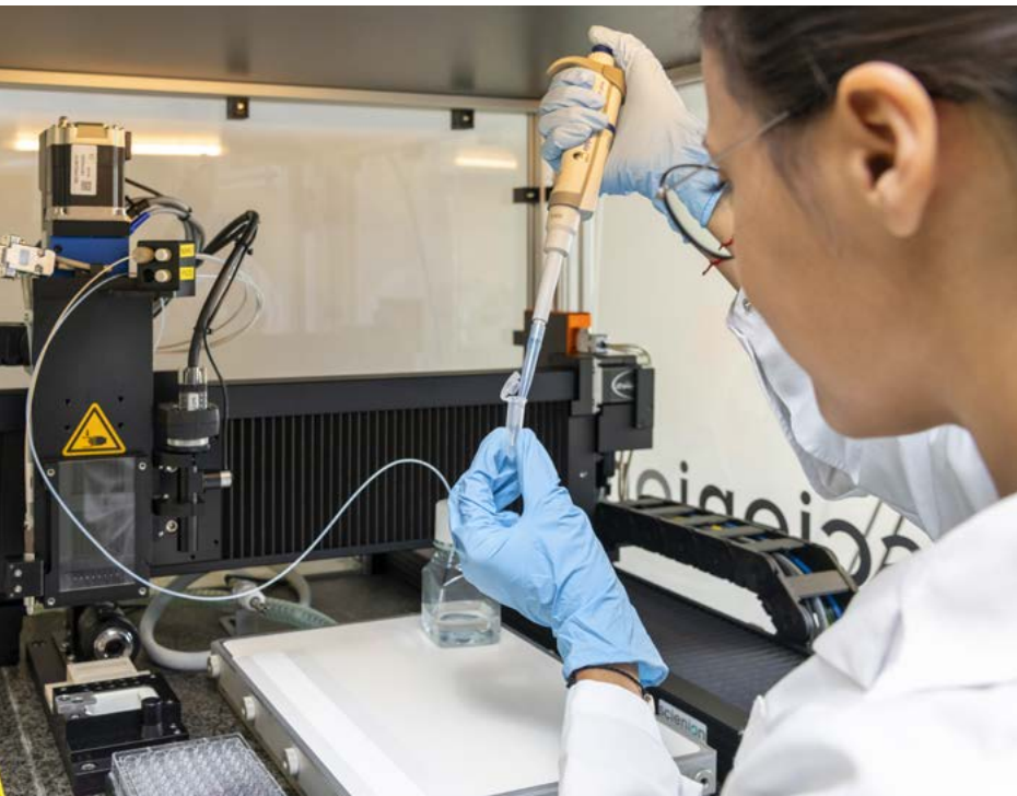
Präparierung der Testmembran mit Antikörpern
