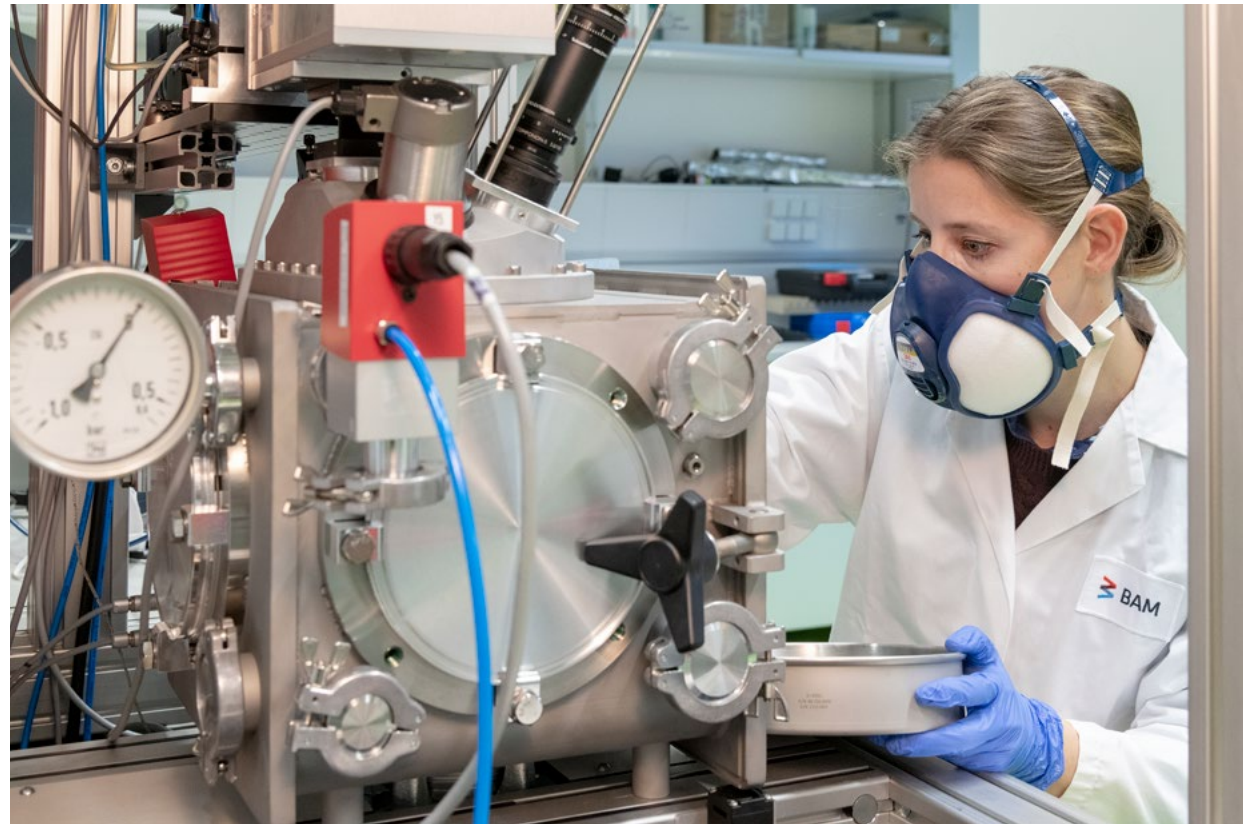
Tina Becker befüllt den 3-D-Drucker mit metallischem Pulver. Tina Becker fills the 3D printer with metallic powder.
