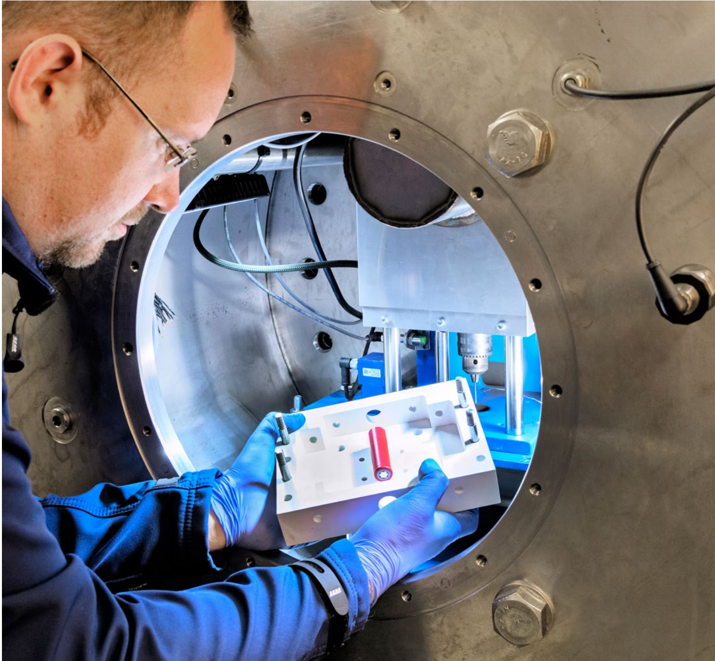
Untersuchungen zur mechanischen Belastung einer Batterie. Impact of the mechanical load on a battery.
