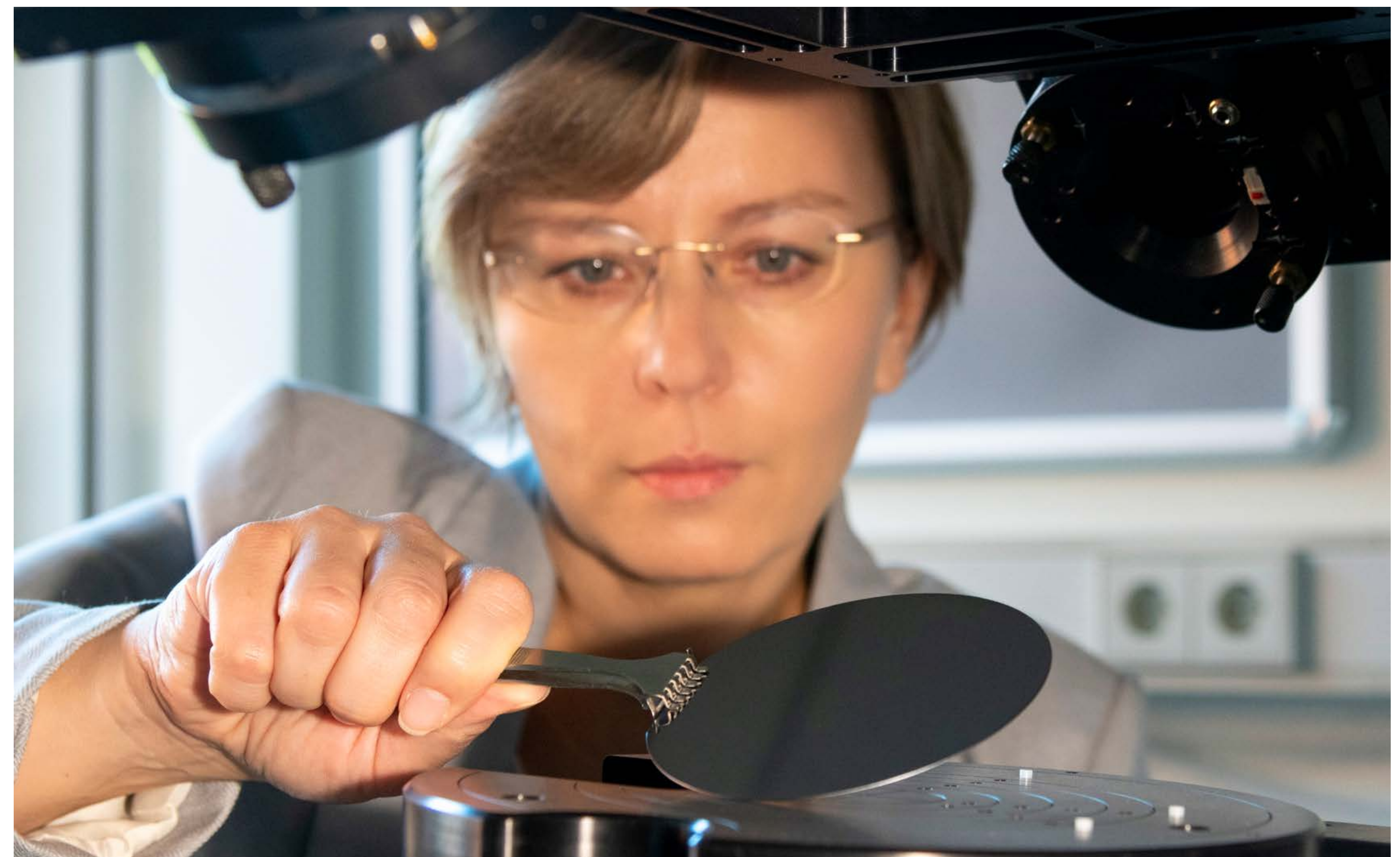
Im Spektrometer lassen sich Fehler im Nanobereich erkennen.
