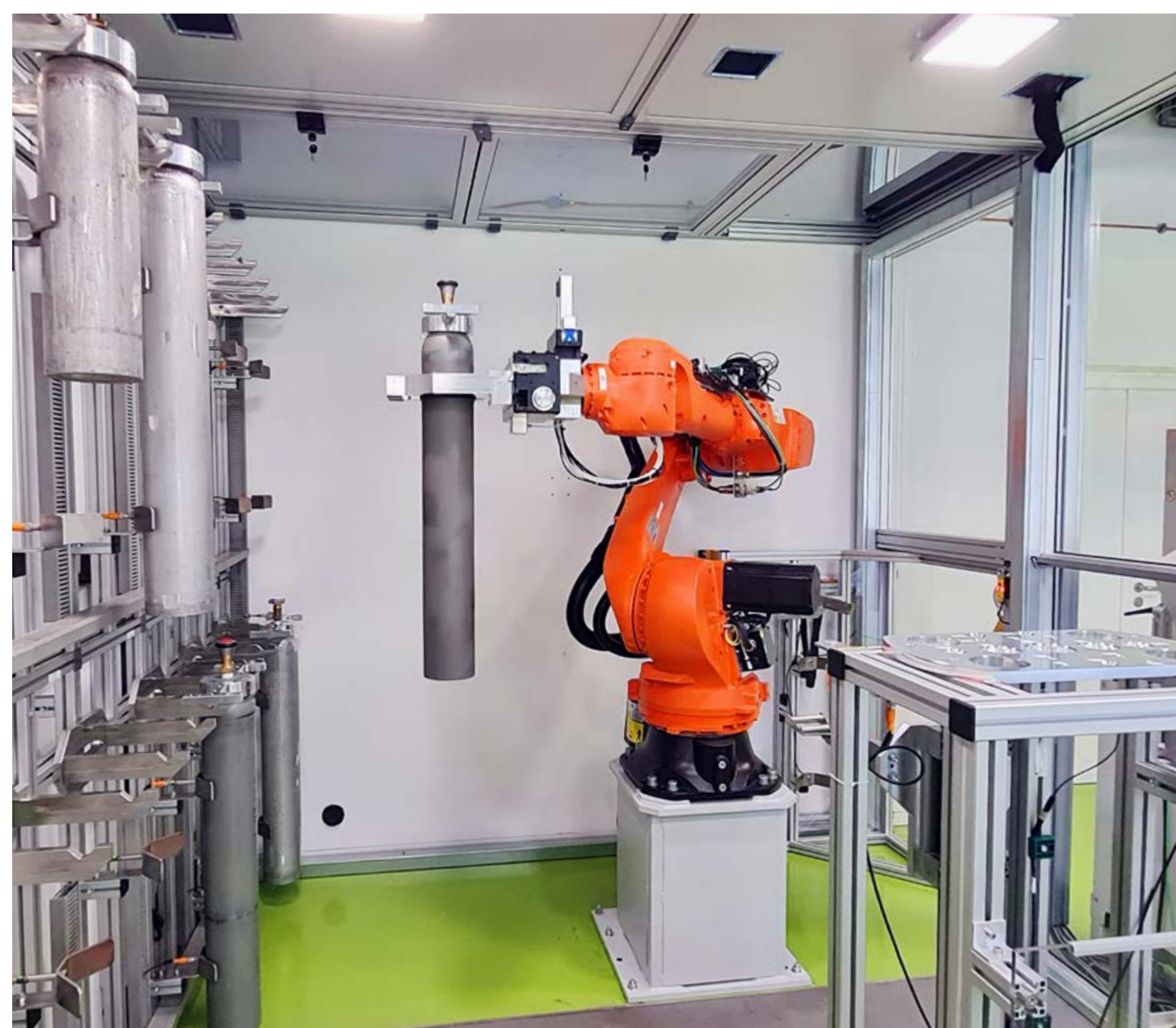
Mithilfe eines Wägeroboters stellt die BAM hochgenaue Kalibriergase her.
