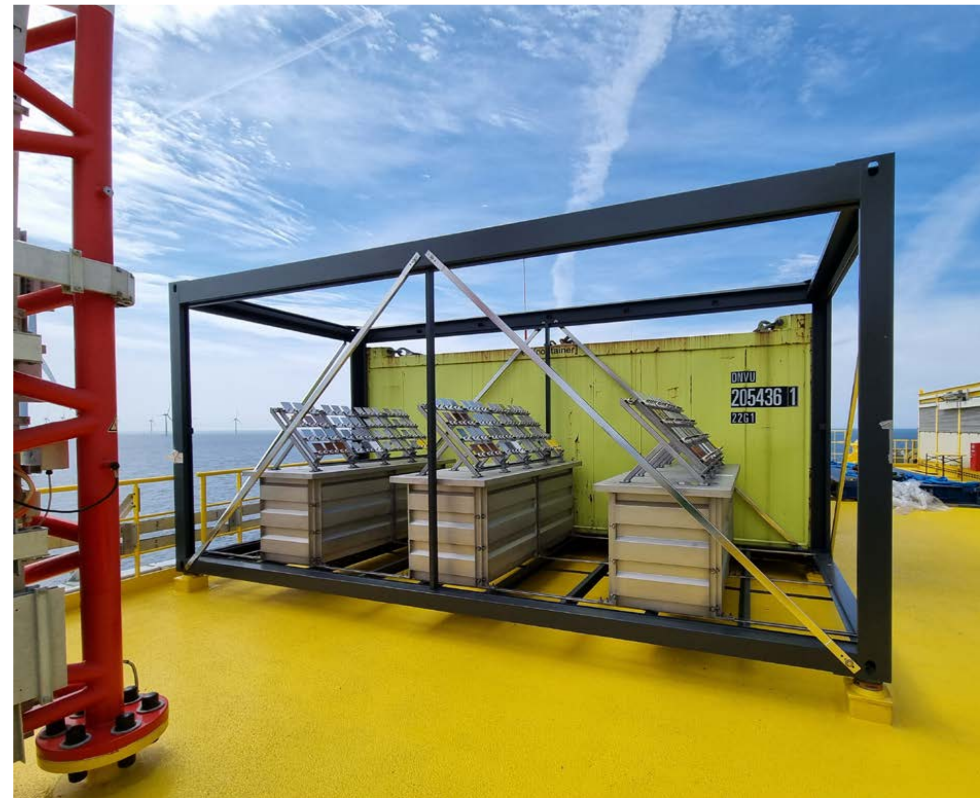
17 verschiedene Werkstoffe und Korrosionsschutzsysteme werden drei Jahre lang bei Wind und Wetter geprüft.
