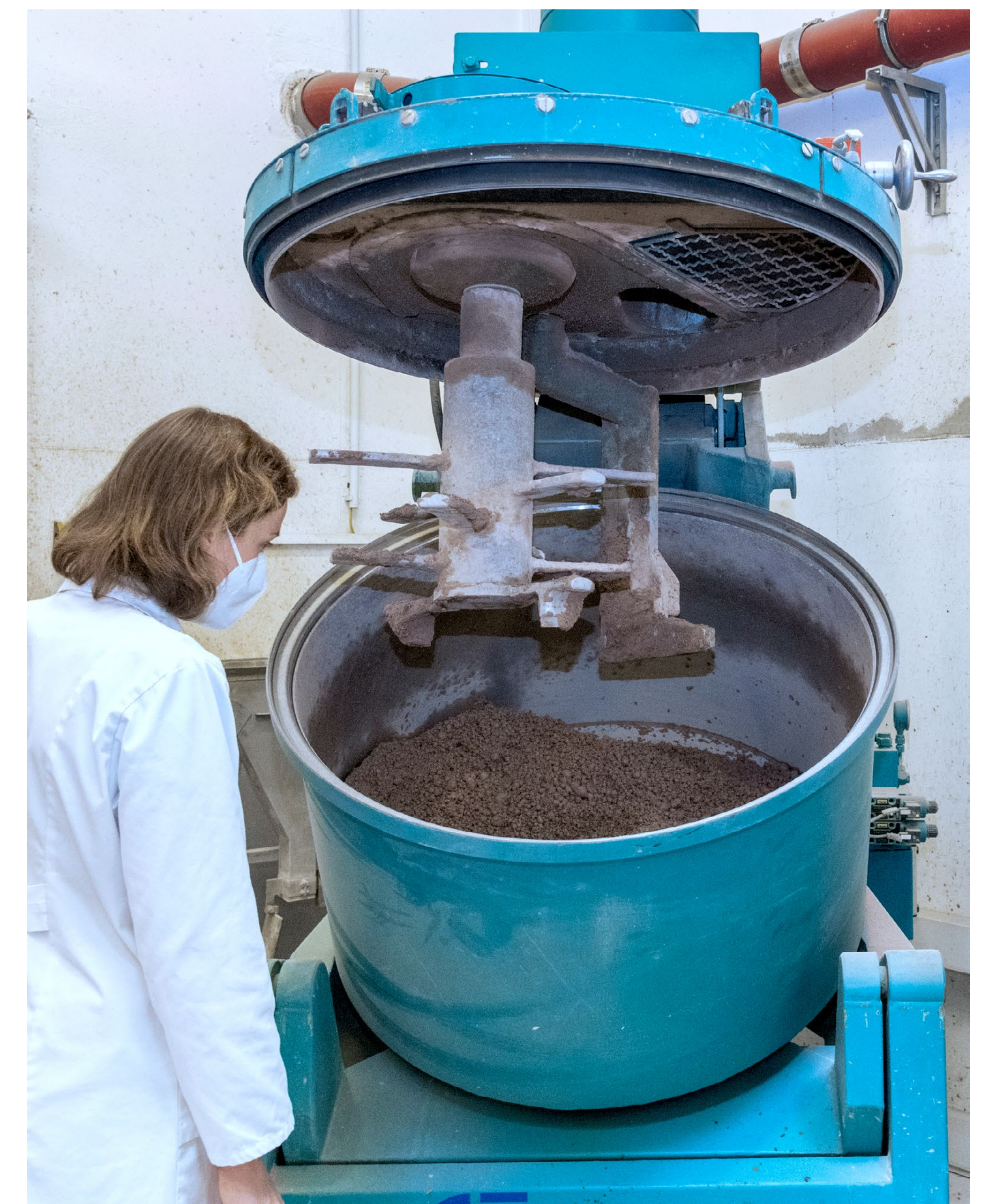
Im Intensivmischer wird das Granulat zu Leichtbeton verarbeitet.
