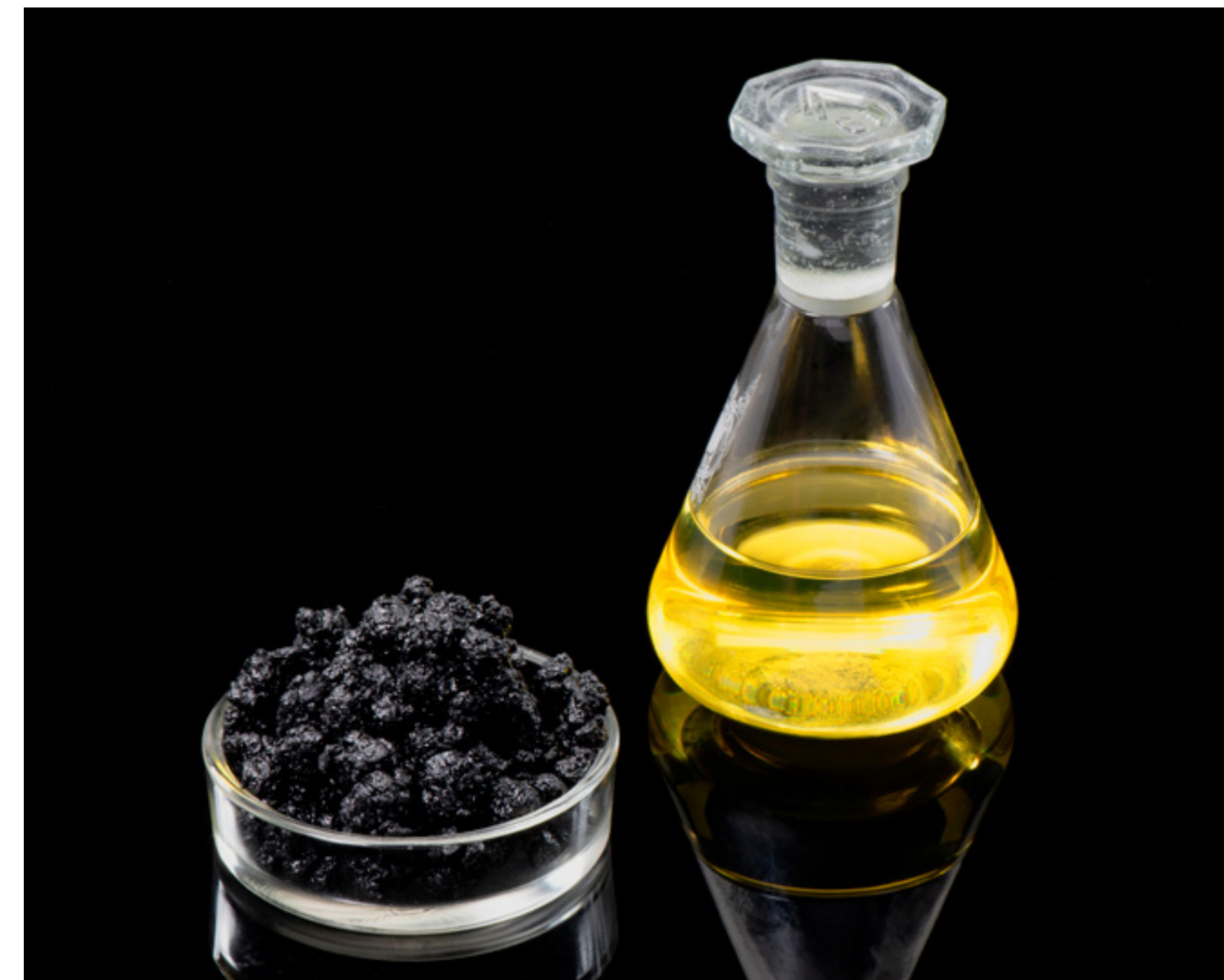
Ein biobasiertes Verjüngungsmittel soll fossiles Bitumen ersetzen.
