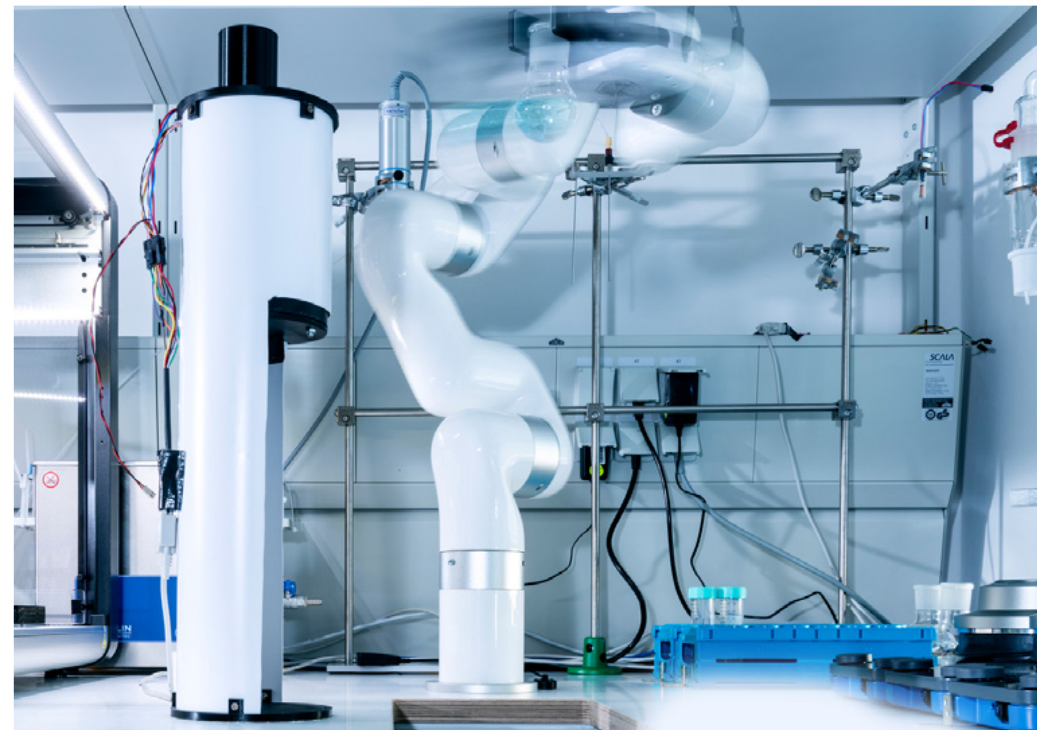
In dem digital gesteuerten System laufen Materialsynthese, -aufreinigung und -analyse nahezu ohne manuelle Eingriffe ab.
