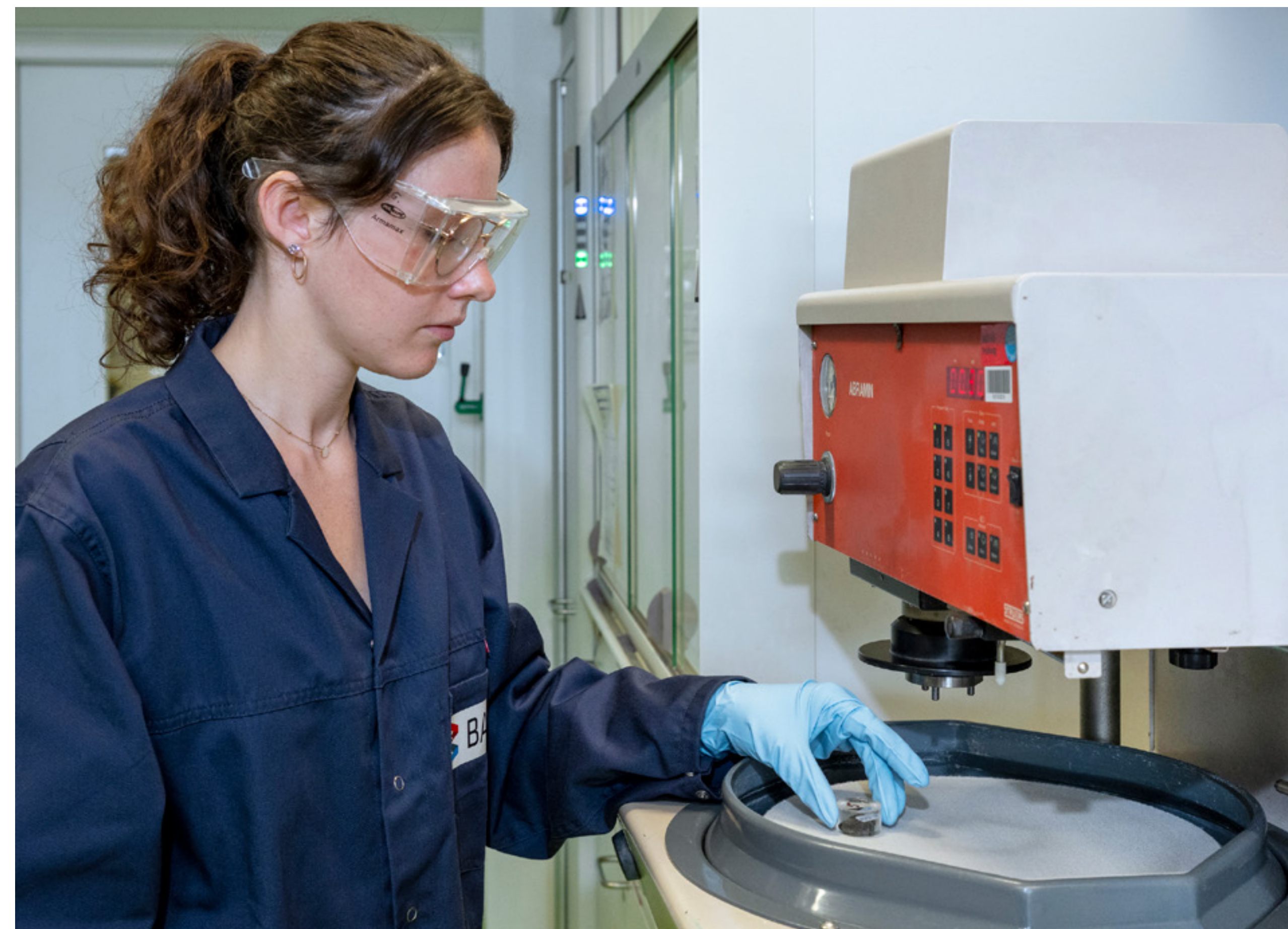
Eisenerproben verschiedener Qualität (r.), Vorbereitung der Proben für mikroskopische Untersuchungen (u.).
