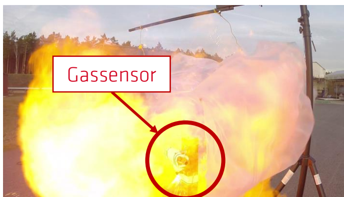
Gassensor in einer unverdämmten Gasexplosion (200 Liter Methan-Luft-Gemisch)
