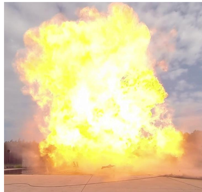
Explosion einer 33kg-Propangasflasche nach einer Unterfeuerung auf dem Testgelände Technische Sicherheit der BAM (BAM TTS)
