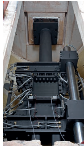
Intermediate-scale Versuchsstand im Stützenprüfofen der BAM
