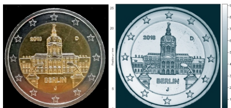
Hochauflösender UT C-Scan der Oberfläche bei 100 MHz mit einer räumlichen Auflösung von 10 µm im Vergleich zu einer Fotografie
