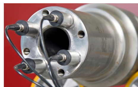
Online-Strukturüberwachung von Eisenbahnradsatzwellen
