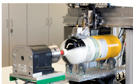
Wirbelstromprüfung von Composite-Druckbehältern
