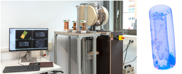
Links: NMR-Tomograph. Rechts: 3D-NMR-Abbild einer Sandsteinprobe im wassergefüllten Glasbehälter, in blau sind hochporöse wassergefüllte Einschlüsse zu erkennen.
