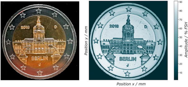
Hochauflösender Ultraschall-Scan einer Oberfläche im Vergleich zu einer Fotografie zur Demonstration der möglichen Detailauflösung
