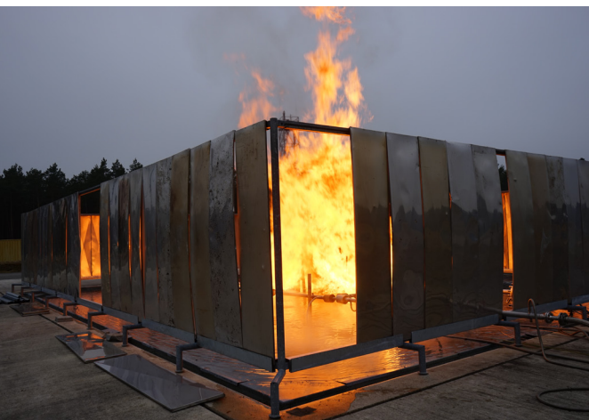
Brandversuch eines Transportbehälters auf dem BAM Testgelände Technische Sicherheit
