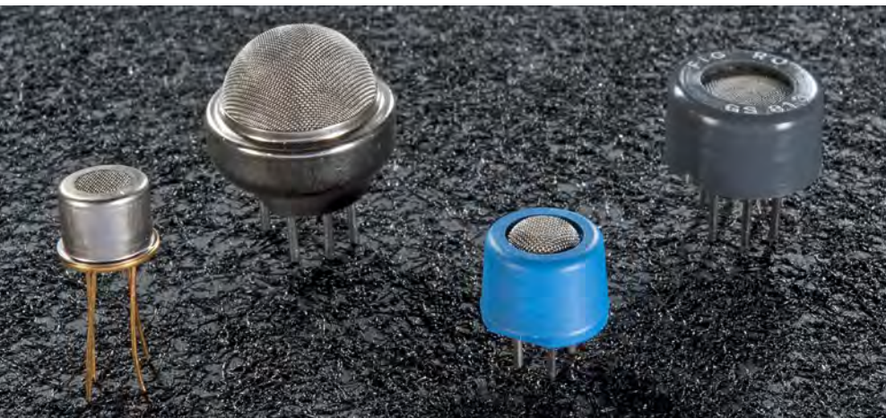
Unterschiedliche H 2 -Sensorentypen
