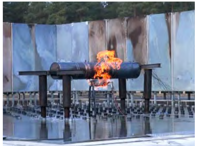
Wasserstoff-Druckbehälter während einer Teilunter- feuerung
