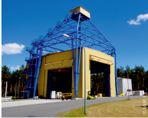
geführter Fallprüfstand S.8
