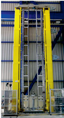
geführter Fallprüfstand S.8
